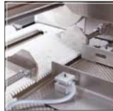
Photocell for NO PHASE - NO PACK function
